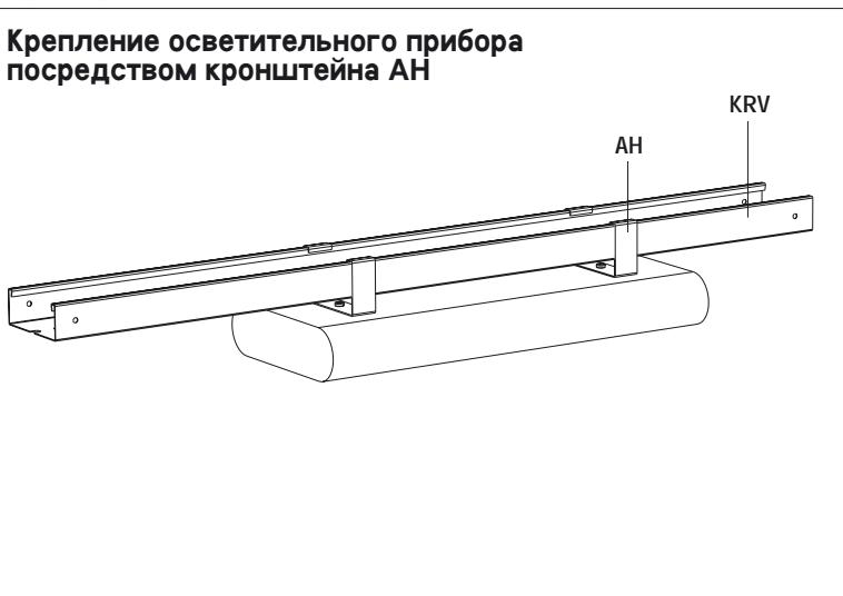
Кронштейн АН крепится к светильнику. Затем светильник вместе с кронштейном подвешивается на предназначеннное для него место к коробу для подвески светильников. Место расположения осветительного прибора можно легко изменить, плавно передвигая его вдоль короба.
