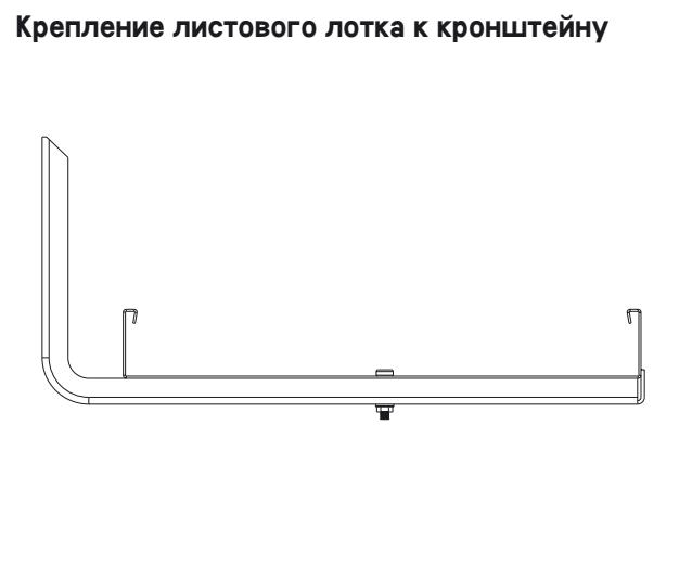
Листовой лоток крепится к верхнестороннему настенному кронштейну YPK двумя стопорными болтами M6x30 и гайками M6.
