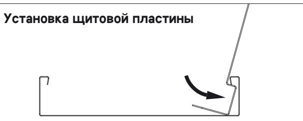
С щитовой пластиной устраняется защитная пленка, пластина RDP вставляется под загнутый борт лотка и прикрепляется к листовому лотку при помощи клейкой ленты. При необходимости, щитовая пластина RDP может крепиться к листовому лотку при помощи болтов.
