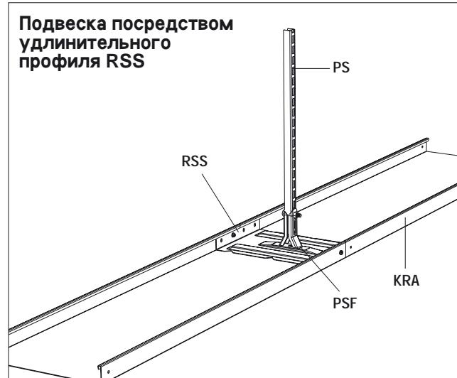
Соорудив конструкцию согласно рисунку, листовой лоток можно подвешивать непосредственно за удлинительный профиль RSS.
