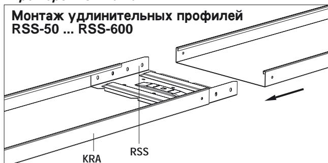
Удлинительный профиль RSS вставляется внутрь листового лотка и крепится прилагаемыми комплектами болтов.
