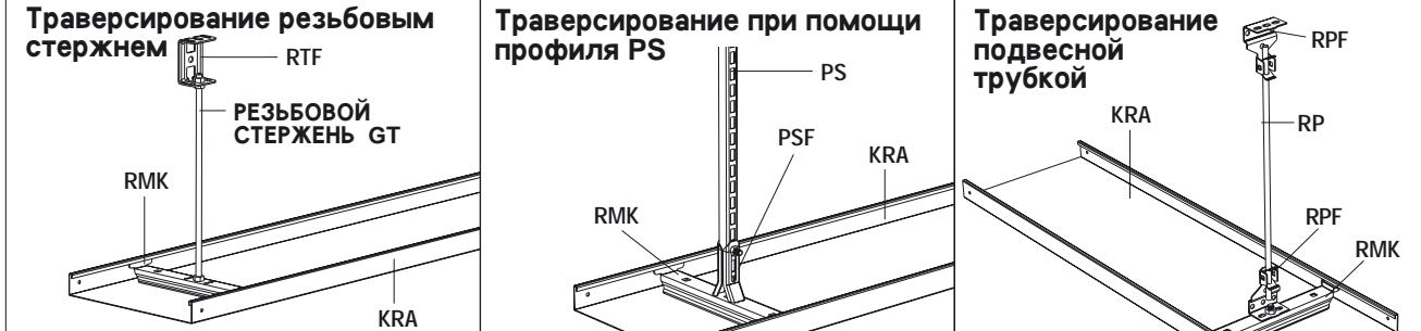
Траверса RMK используется при подвеске листового лотка в его среднеосевой части. Траверса RMK крепится к резьбовому стержню GT двумя гайками.
