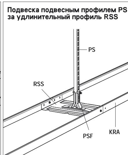
Скобы PSF для профиля PS крепятся к удлинительному профилю RSS. Подвесной профиль PS крепится к скобам прилагаемым комплектом болтов.
