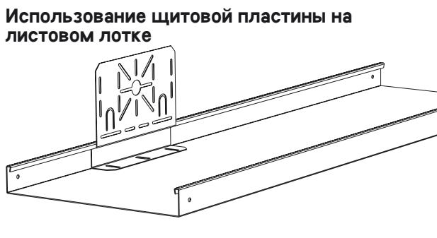
Пластина щитовая RDP применяется в системе листовых лотков в качестве крепежного основания для распределительных коробок.
