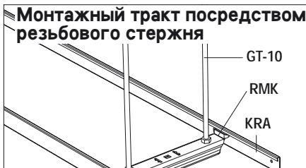
Траверса RMK может быть использована также при сооружении монтажного тракта. Траверса RMK крепится к резьбовому стержню GT-10 двумя гайками.
