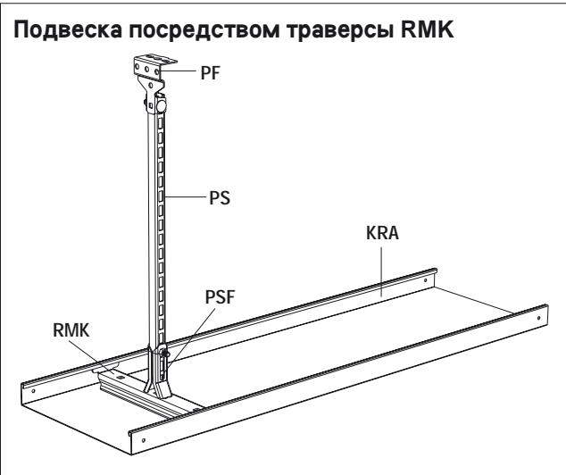
Использование представленной на рисунке конструкции гарантирует очень прочную подвеску при помощи траверсы.
