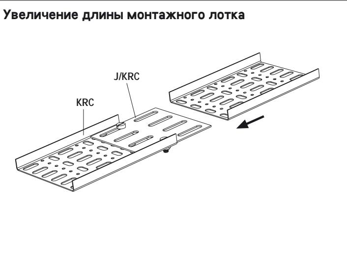
Монтажный лоток KRC увеличивается за счет применения удлинительного профиля J/KRC. Удлинительный профиль крепится прилагаемыми к изделию болтами.
