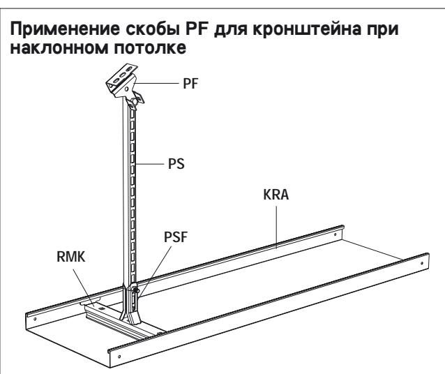
В случае наклонного потолка скоба PF крепится к подвесному профилю PS согласно рисунку.
